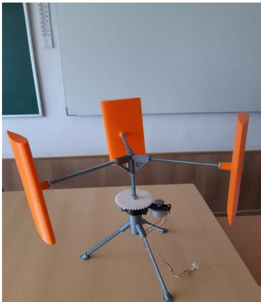
Рисунок 2 – Виготовлена модель Н-ротора Дар'є
