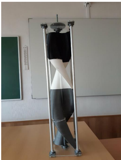
Рисунок 1 – Виготовлена модель віротурбіни Савоніуса спірального типу
