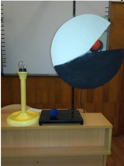
Рисунок 2 – Установка для проведення досліду по спостереженню парадоксу Вільяма Генрі Брегга
